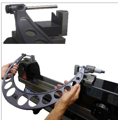
Contrôle manuel de grands micromètres (TEL5, TEL11)
